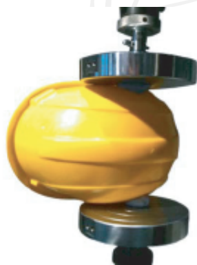
Prueba cíclica EN 397 Pruebas de compresión Cascos de seguridad industrial
