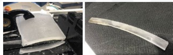
Vidrio de silicona de arco (Rebanada fina de 2 mm)
