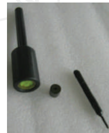
Die: \Phi 2.095 \pm 0.005 Die cleaning rod
