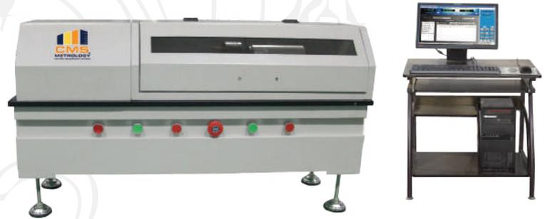
La máquina de prueba adopta una operación de control por computadora, que puede realizar una prueba de par de ángulo fijo; el software muestra la curva de ángulo - par de la pieza probada, visualización en tiempo real del ángulo, par, velocidad de torsión, retención de pico de par, estado de funcionamiento de la máquina de prueba, almacenamiento de datos de prueba e informe de prueba de impresión y otro contenido de parámetros.
