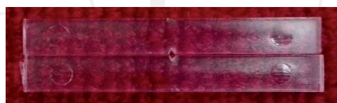
Muestra de impacto de muesca en V de vidrio orgánico 80 * 10 * 4 mm
